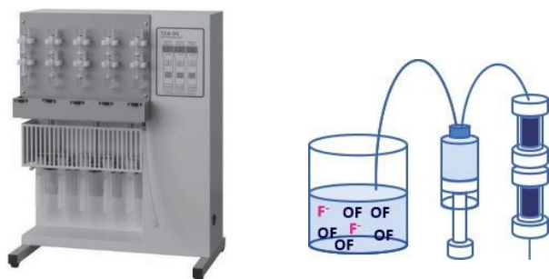
Fig. 8 Aspecto y esquema conceptual de la unidad de adsorción TXA-04
