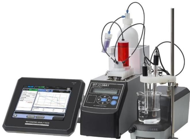
El análisis está basado en una Valoración potenciométrica y esta efectuado con el valorador **GT-310**.
