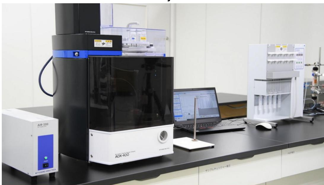
Esta unidad fue diseñada específicamente para la preparación de muestra de acuerdo al método de columna (DIN 38409 H14). La muestra atraviesa verticalmente las columnas que contienen el carbón activado. Según las normas aceptadas el carbón activado posteriormente es lavado con una disolución de nitrato. Finalmente, el contenido de AOX procede a ser determinado.
