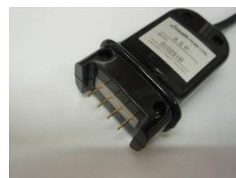
Figura 3.3.2 Sonda de cuatro puntos
