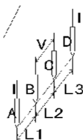
Figura 3.3.2 Sonda de cuatro puntos
