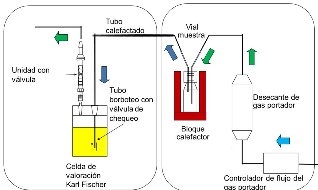
El sistema automatizado para la determinación de agua ofrece unas ventajas claras frente al vaporizador manual:
