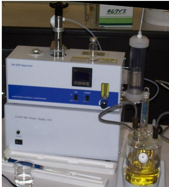
Estos productos se encuentran en pequeñas cantidades y en ampollas selladas mediante un septum precisándose determinar el contenido de Humedad completa de la ampolla. Si el contenido del mismo se transfiere a un sistema analítico los valores blancos fluctúan introduciendo innecesarias fuentes de error.
