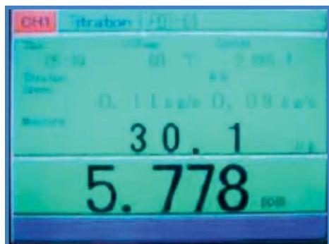
La determinación Karl Fischer con la solución propuesta por Nittoseiko automatiza inyecciones sucesivas desde un mismo recipiente de muestra y permite obtener el cálculo final del resultado de un modo automático adicionalmente permite la obtención de estadísticas y obtener informes de resultados vía Impresora o USB.
