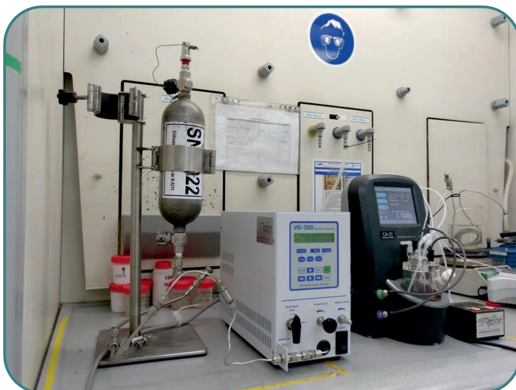
Figura 1 - VG-200 asociado a CA-31 celda reactivo único y dosificador/evacuado de reactivo KF-SD
