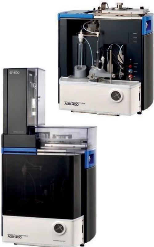
Instrumento de medición de análisis de AOX: Valoración de la calidad del agua contaminada por halógenos orgánicos por adsorción de carbón activado.
